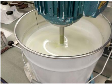
1a) Mixing of PVB topcoat and polyester primer
